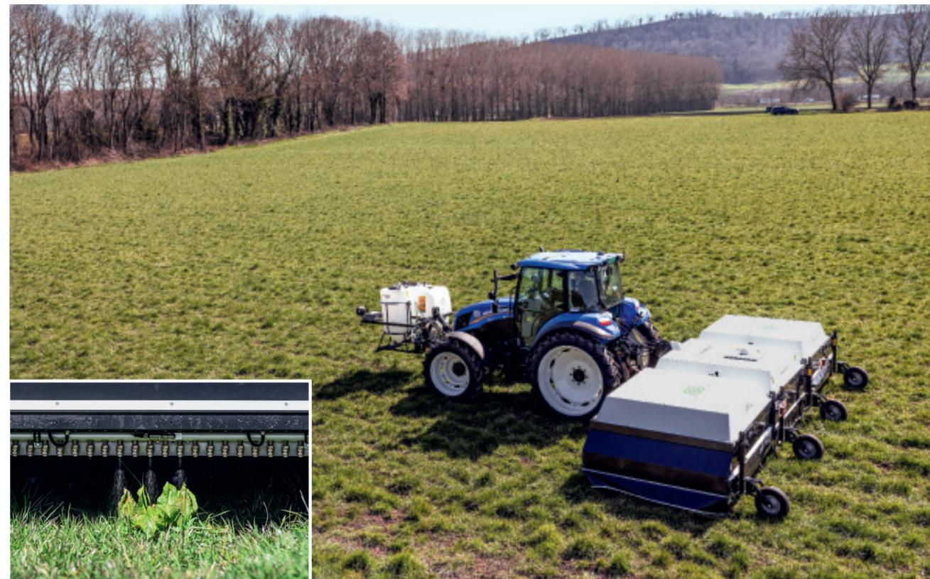
La barra polverizzatrice ad alta precisione ARA di ecoRobotix non sparge i diserbanti a pioggia come farebbe un trattore, ma li dosa praticamente col contagocce. Il 5G permetterà all’ARA di raccogliere i dati, di elaborarli e di comunicare le sue conclusioni all’agricoltore.
