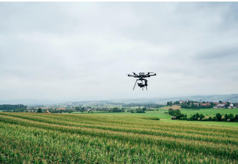
Già oggi sulle coltivazioni volano droni muniti di sensori in grado ad esempio di misurare la crescita delle piante. Ciò consente di stabilire la quantità di biomassa, che a sua volta serve per calcolare il contenuto di azoto.
