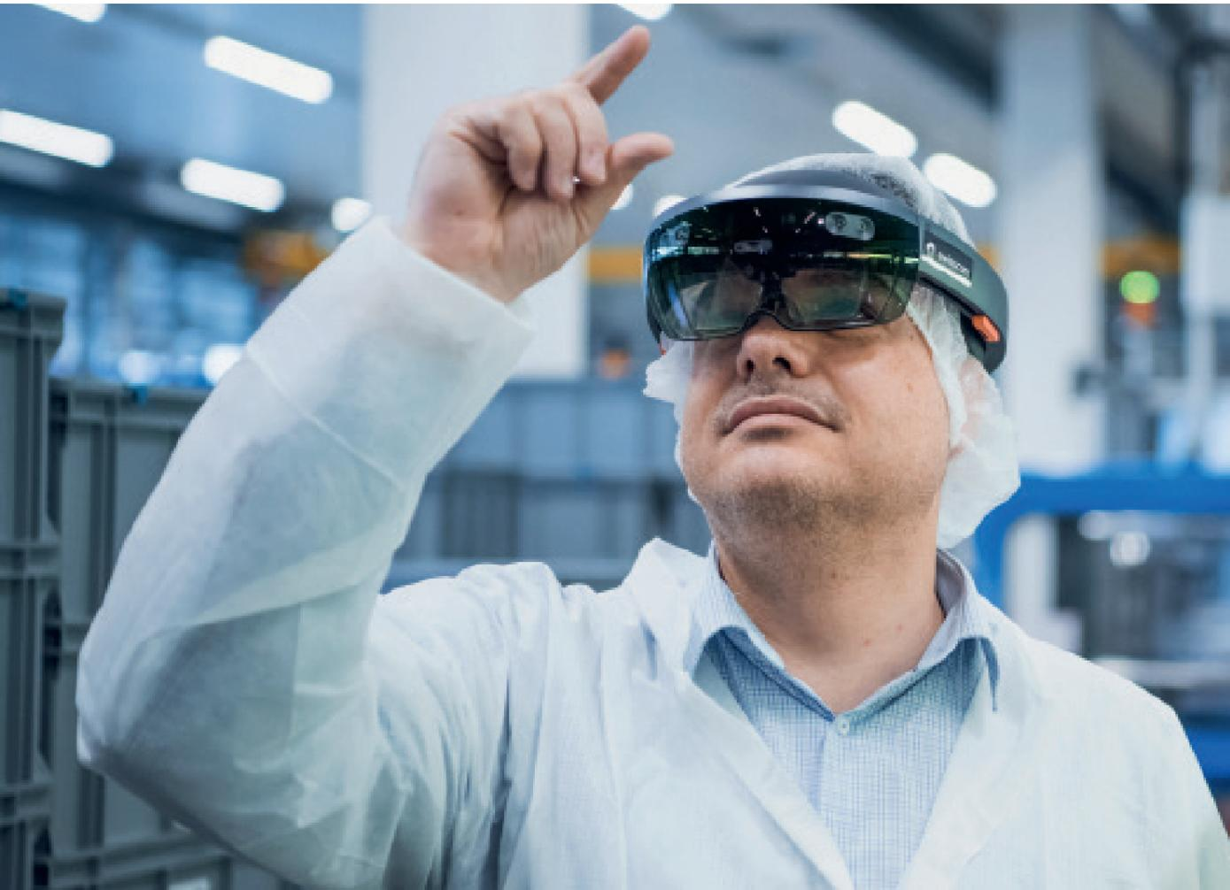
*Gli occhiali a realtà aumentata possono essere utilizzati per arricchire l'ambiente fisico con contenuti digitali, per esempio con menu operativi digitali per il controllo, il test o la misurazione dei prodotti. Ecco perché nell'esempio mostrato da Ypsomed sembra anche che chi indossa gli occhiali stia cliccando «in aria».* Foto: Swisscom
